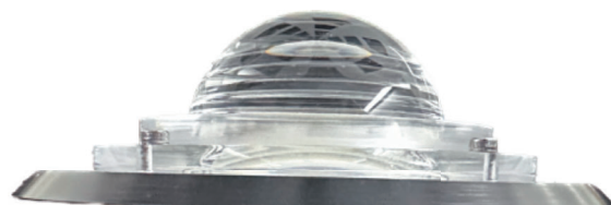
図4 レンズ作成手順、レンズデータ表（mm単位）、そして作成したレンズ。この焦点距離 f=158\text{mm} メニスカス・レンズは \pm 85^\circ の広視野、狭い直径 D=0.7\text{mm} 瞳孔のテストレンズのために設計されています。
