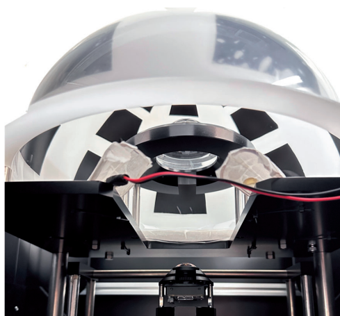
図2 レンズ検査装置：写真では、テストされる魚眼レンズが下、メニスカス・レンズが真ん中、パターンドームが上に見えます。
