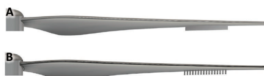
図1 ドローン用低騒音プロペラ。通常のプロペラ (70.5 dB) に対して、(A) 後縁に板を取り付けたプロペラは騒音が増大する (73.7 dB)。一方、この板を (B) 微細構造にすることで、騒音を抑制できた (69.2 dB)。
