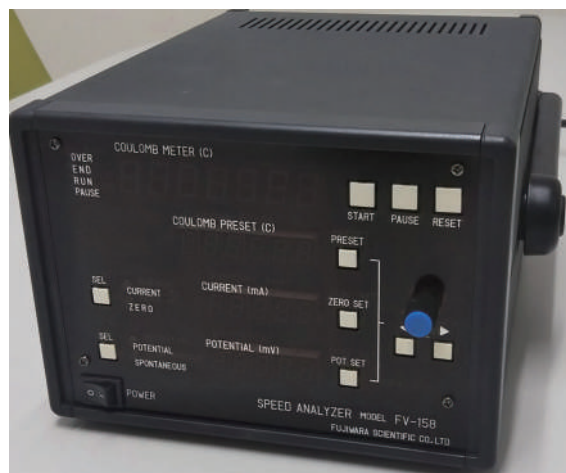
図1 定電位電解エッチング装置
