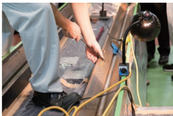
図2 キサゲ加工の様子
