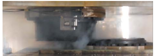
図1 積層ゴムの終局耐力を確認するための試験
