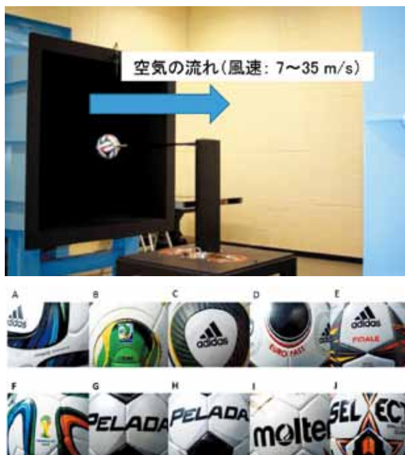
図1 サッカーボールに作用する流体力の測定実験装置および対象としたボールの種類 (文献 (2) より一部改変)
