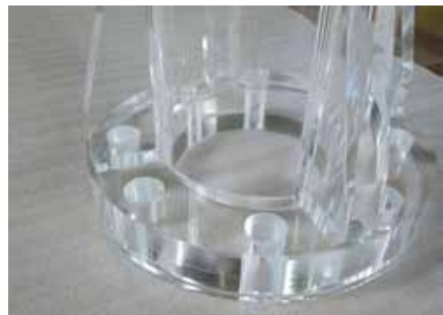
写真2 エンプラ（切削と接着を組み合わせた配管）
