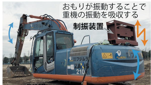
図1 解体重機に設置された制振装置
