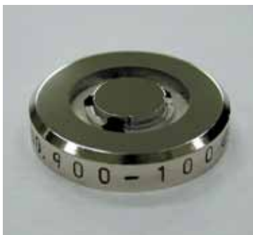
図1 タングステン単結晶製硬さ基準片
